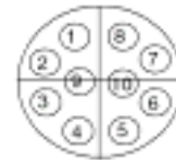
SPS-Kabel (Ansicht auf CAMAT-Gehäuse)
