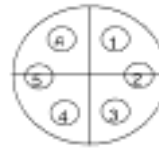
RS-232-Schnittstelle (Ansicht auf CAMAT-Gehäuse)
