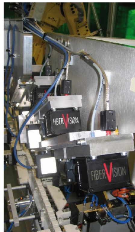
Blick auf eine Anlage mit vier Kameras, die damit 3.600 Produkte pro Stunde inspiziert
